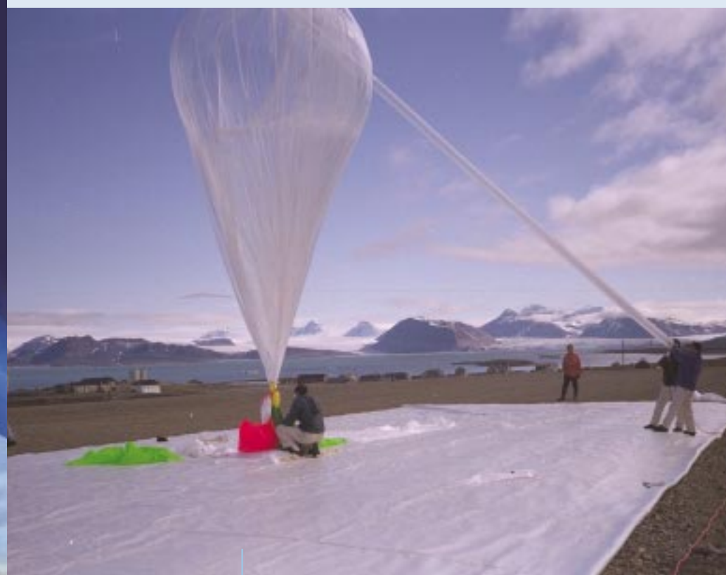
▼ AUFSTEIGER: DIESER STRATOSPÄRENBALLON KOMMT BIS IN HÖHEN VON 50 KILOMETERN UND UNTERSUCHT DORT DIE OZONSCHICHT. ER IST AM ERDBODEN NUR LEICHT AUFGEBLÄHT, DAMIT ER BEI DEM GERINGEN DRUCK IN GROSSER HÖHE NICHT PLATZT. (FOTO: AWI)
